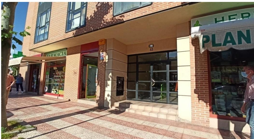
Se propone como solución la instalación de una rampa, situada en la acera con dos tramos, que solucionará la accesibilidad al portal y al local situado a la izquierda del mismo (Farmacia). Al ir contrapendiente, la longitud necesaria de rampa necesaria es menor
