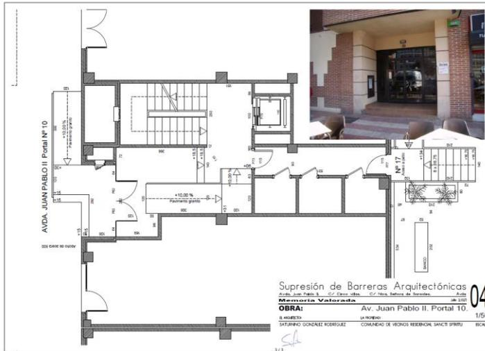
La propuesta presentada adopta, como solución la instalación de una rampa, situada en la acera, paralela a la fachada, con un tramo inclinado de 3 metros y el 10% de pendiente. La meseta situada a la misma cota que el suelo del porche de acceso al portal, no cumple las dimensiones y características establecidas por la Normativa.
