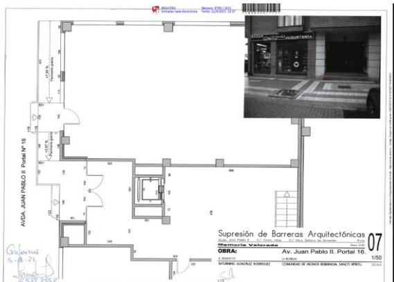
La solución propuesta consiste en la ejecución de una serie de rampas paralelas a fachada con plataformas de desembarco en el nivel del portal y en el nivel del local ↔ rampa en dos tramos, el primero desde la vía pública hasta una meseta situada en la puerta de acceso al local y el segundo hasta el porche de acceso al portal.
